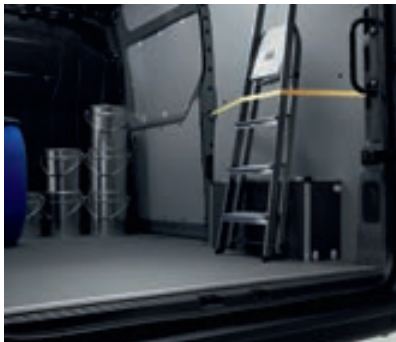
Zijwanden en vloer antislip-polypropyleen 6 mm
